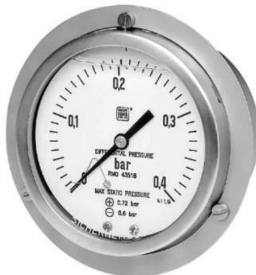
Instrumento idóneos para indicar las presiones diferenciales de fluidos gaseosos o líquidos que no presenten una viscosidad elevada, no cristalizables. Pueden conectarse separadores para en los casos en que el fluido de proceso sea corrosivo, temperaturas altas y viscosidades elevadas o cristalizables.
